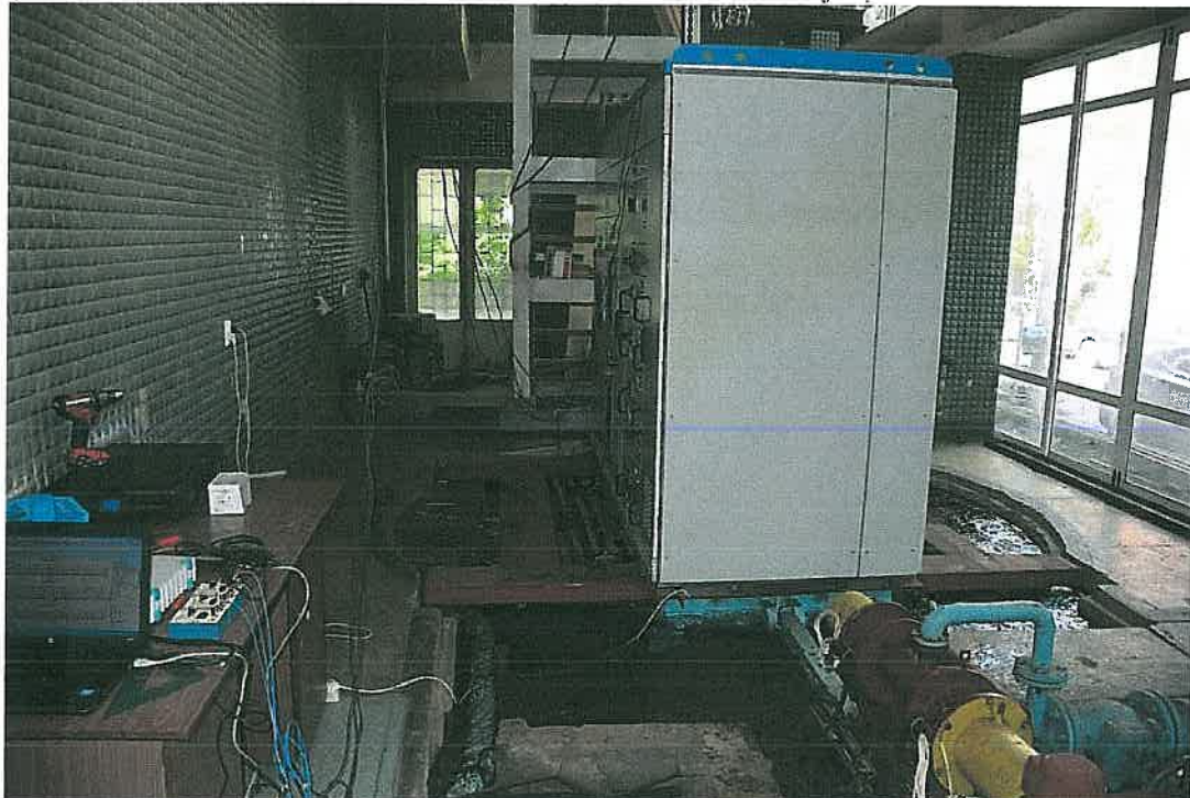
F7 - Laborator de încercări seismice cu platforma de încercări de capacitate 13,5 tf (situat în Stația seismică din Str. Gh. Asachi 3-5, foto mai jos)
