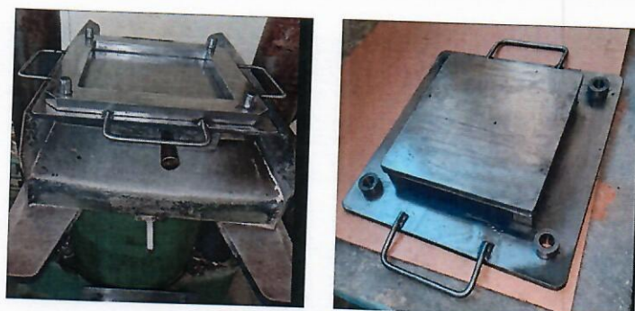
Fig. 13. Aspect general matriță de presare eco-materiale, amplasată parțial pe platanul presei (stânga) și capacul matriței (dreapta)
