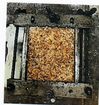
Fig. 15. Hurd (stânga) și palee (dreapta) impregnate 24 ore în soluție de amidon 40%, la introducerea în matrițe
