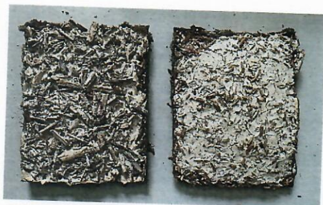
Fig. 14. Amestecuri de palee și hurd în soluție de amidon 40% după 24 ore, hurd (stânga), palee (dreapta)
