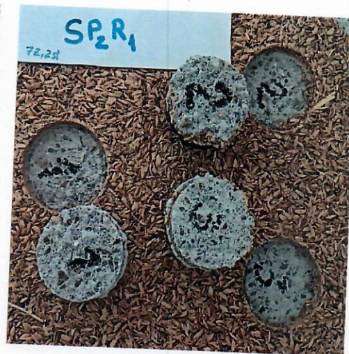
Fig. 4. Aspectul acoperirii bistrat SP2R1, cu conținut de palee de orez, determinarea aderenței la beton, după 7 zile (Aplicarea II)
