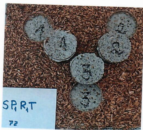
Fig. 7. Aspectul acoperirii bistrat SP1R1T30, cu conținut de palee de orez și fire de cânepă, determinarea aderenței la beton, după 7 de zile (Aplicarea III)
