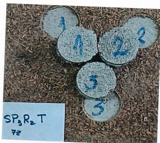
Fig. 9. Aspectul acoperirii bistrat SP3R2T, cu conținut de palee de orez și fire de cânepă, determinarea aderenței la beton, după 7 zile (Aplicarea V)
