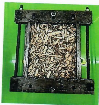
Fig. 15. Hurd (stânga) și palee (dreapta) impregnate 24 ore în soluție de amidon 40%, la introducerea în matrițe
