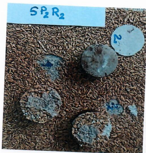
Fig. 3. Aspectul acoperirii monostrat SP2R2, cu conținut de palee de orez, determinarea aderenței la beton, după 7 zile (Aplicarea I)
