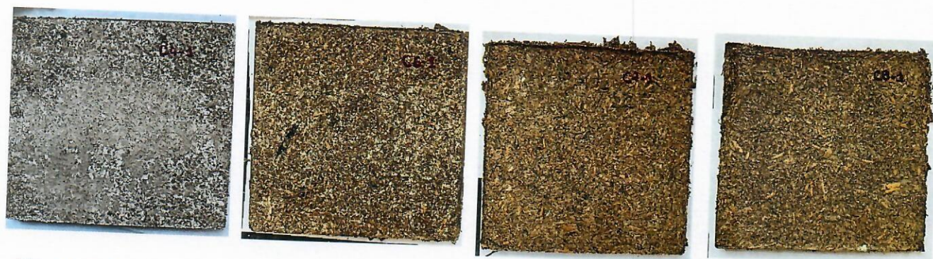
Fig. 19. Plăci obținute în matrița de mari dimensiuni, cu reducerea umidității în masa materialului. De la stânga la dreapta, variantele compoziționale C4.1, C6.1, C7.1 și C8.1
