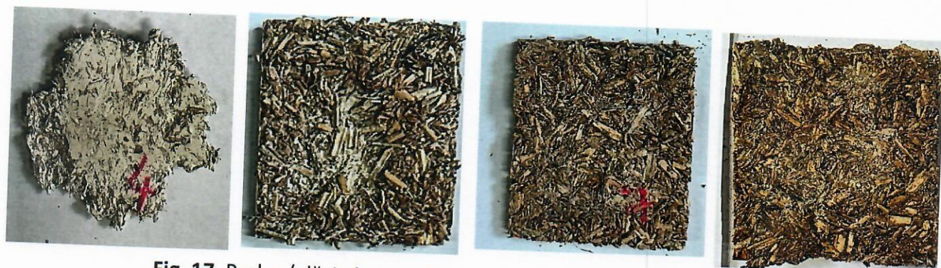
Fig. 17. Probe /plăci obținute în matrițe metalice de mici dimensiuni. De la stânga la dreapta, variantele compoziționale C4, C6, C7 și C8
