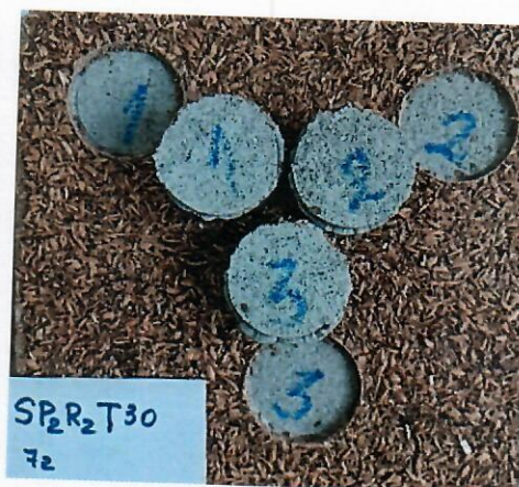
Fig. 8. Aspectul acoperirii bistrat SP2R2T30, cu conținut de palee de orez și fire de cânepă, determinarea aderenței la beton, după 7 zile (Aplicarea IV)
