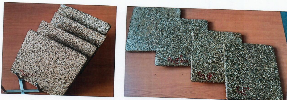
Fig. 3. Produse de acoperire prin placare obținute prin integrare de S.A.N.
