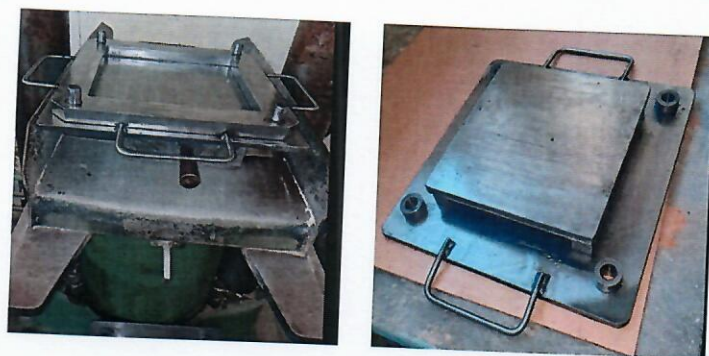
Fig. 2. Aspect general matriță de presare eco-materiale, amplasată parțial pe platanul presei (stânga) și capacul matriței (dreapta)
