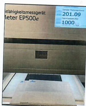
Fig. 2. Plăcile –suport de gips-carton, în vederea introducerii în conductivimetru (stânga); Detaliu privind aspectul acoperirii testate (mijloc); Aspect din timpul testării unei acoperiri (dreapta)
