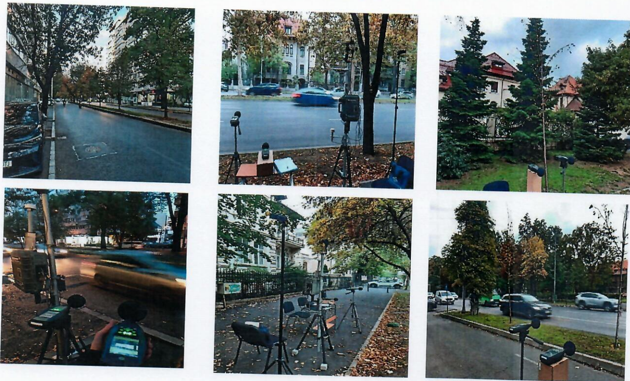
Fig. 17. Aspecte din timpul măsurătorilor acustice pe cele trei profile stradale selectate
