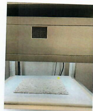
Fig. 2. Plăcile –suport de gips-carton, în vederea introducerii în conductivimetru (stânga); Detaliu privind aspectul acoperirii testate (mijloc); Aspect din timpul testării unei acoperiri (dreapta)
