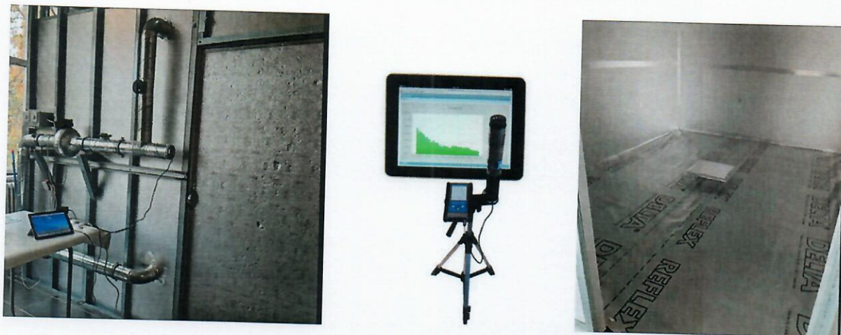
Fig.4. Standul experimental S2 (stânga), sonda DirectSense IQ-610 (mijloc) și proba cu produsul de testat (dreapta)
