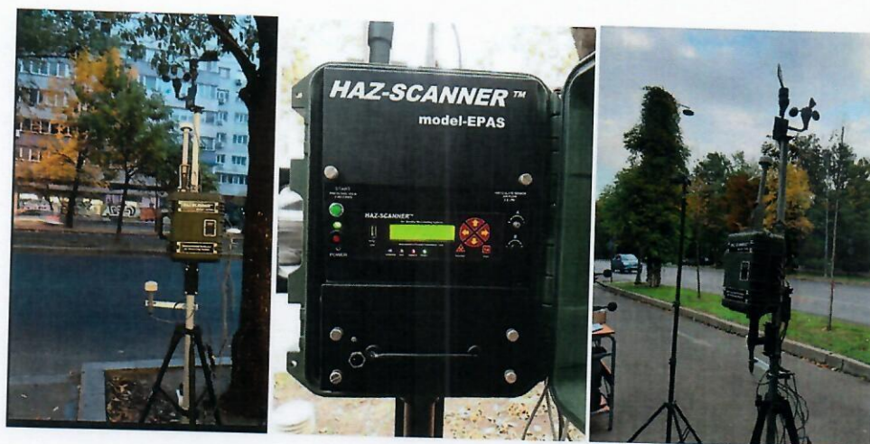
Fig. 18. Monitorizarea parametrilor climatici cu echipamentul model HAZ-SCANNER, în locațiile din B-dul Nicolae Titulescu (stânga) și Șos. Kiseleff (dreapta)
