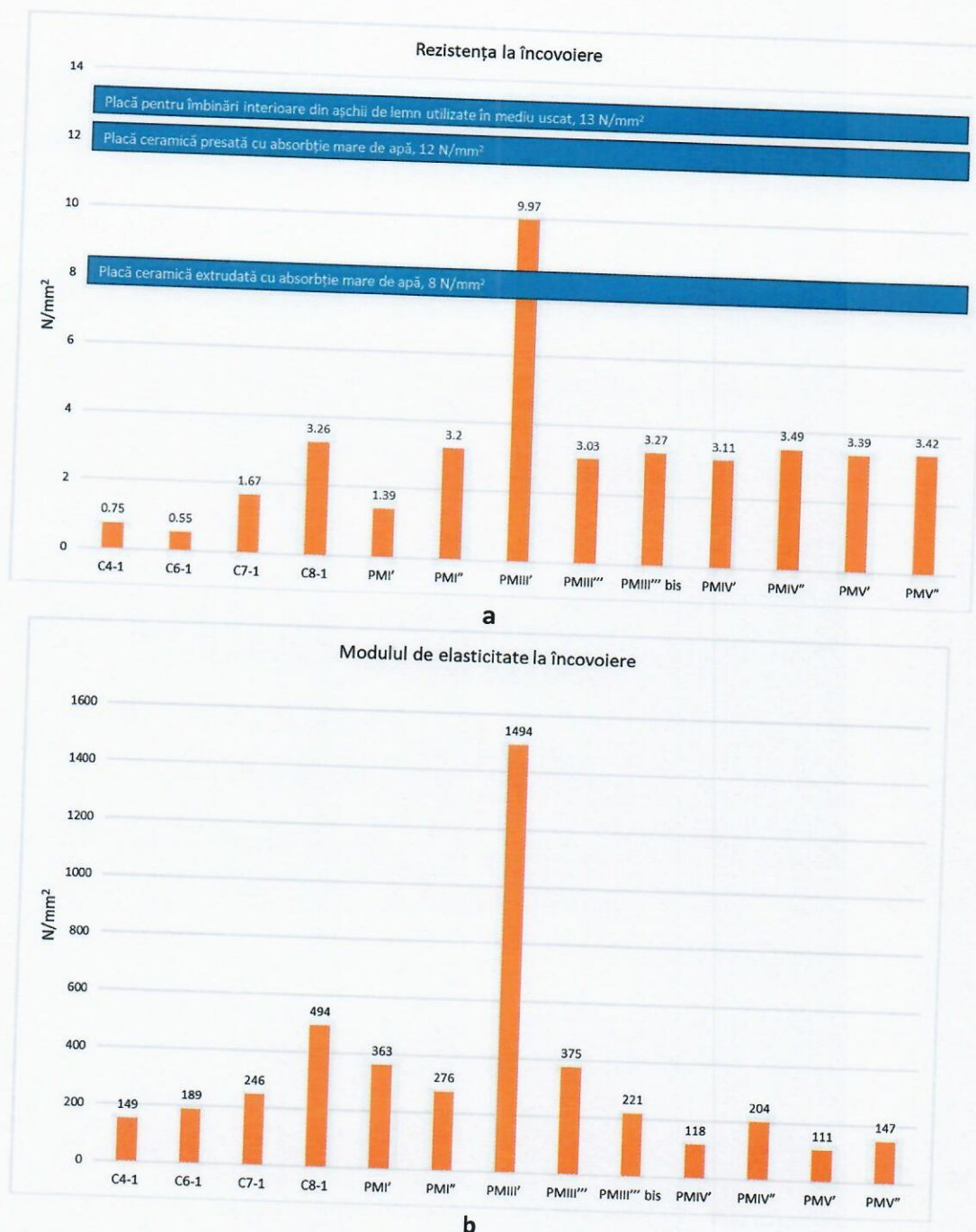
Fig. 13. a, b. Reprezentare a rezistenței/modul de elasticitate la încovoiere pentru plăcile prototip
