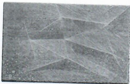
Prototip panou geopolimer activat alcalin cu adaos de \text{TiO}_2
